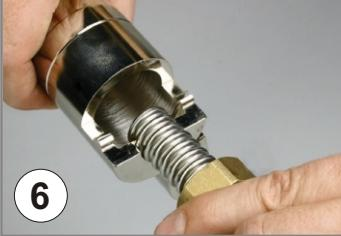
Отрезать трубу необходимой длины (1), вставить оконечную часть трубы в специальное приспособление арт. 4529T1225 с соответствующим зажимом (6). Закрыть зажим и многократно произвести удара рукояткой (7).
