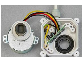
Nella valvola a sfera motorizzata non ci sono contatti elettrici. La posizione del rubinetto a sfera è determinata da un metodo ottico contactless, che garantisce un alto grado di precisione e affidabilità durante il funzionamento.
