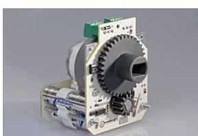
La posizione della valvola a sfera è determinata da un metodo ottico contactless, che garantisce un alto grado di precisione e affidabilità durante il funzionamento.
