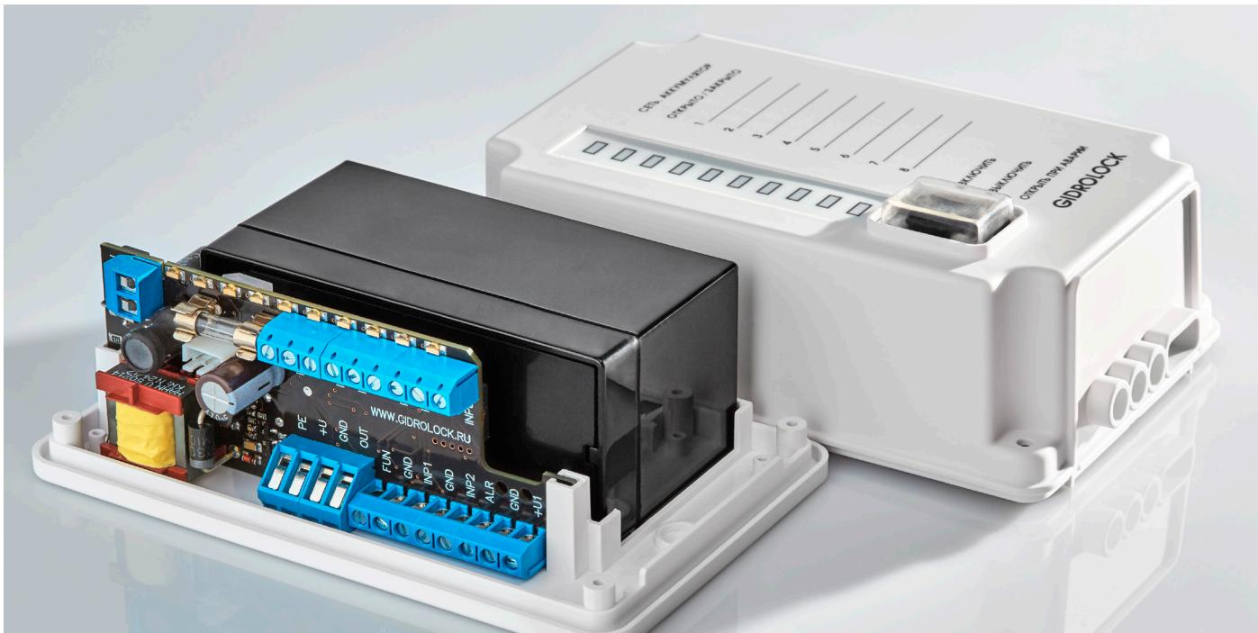
L'unità di controllo è un elemento del sistema GIDROLOCK TIEMME ed è destinata al monitoraggio dello stato dei sensori di perdite d'acqua collegati, al controllo delle valvole a sfera motorizzate e all'emissione di un allarme acustico in caso di incidenti negli impianti di fornitura dell'acqua e del riscaldamento.
