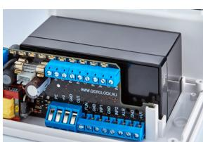
Il sistema GIDROLOCK TIEMME è dotato di una fonte di alimentazione continua grazie ad una potente batteria di accumulatori. In caso di interruzione di alimentazione, il sistema funziona a batteria. Quando la tensione della batteria ad accumulatori scende al di sotto di un certo livello, sarà emesso un segnale acustico.
