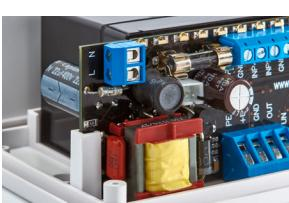
L'unità di controllo utilizza una fonte d'alimentazione integrata altamente affidabile, che fornisce protezione da cortocircuito all'uscita, sovraccarico di corrente, sovratensione.
